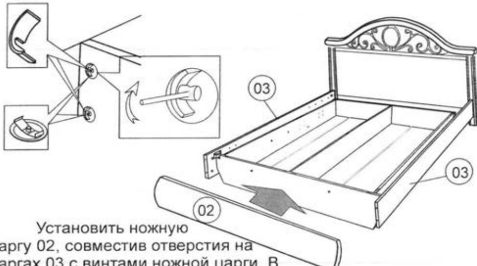
Установить ножную царгу 02, совместив отверстия на царгах 03 с винтами ножной царги. В отверстия вставить сегменты и с помощью шила завернуть винты кроватной стяжки до упора. В отверстие вставить заглушки.
