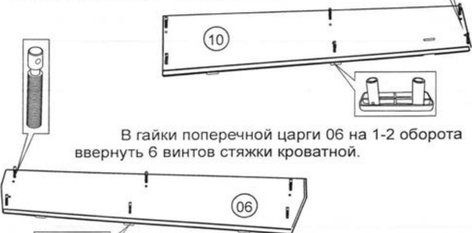
В гайки поперечной царги 06 на 1-2 оборота ввернуть 6 винтов стяжки кроватной.
