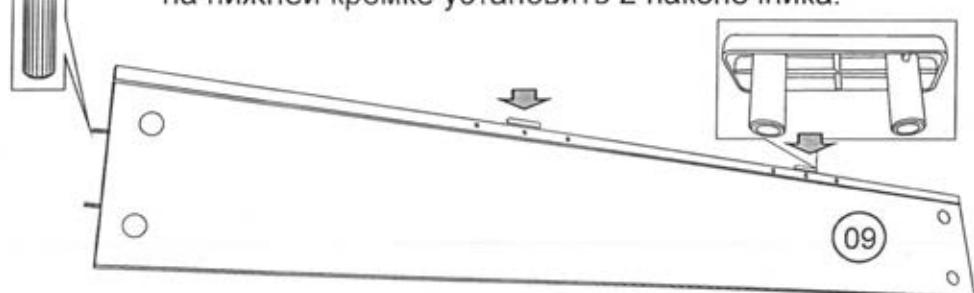
В отверстия на пласти рёбер жесткости 01.05 установить по 4 эксцентрика и 1 наконечнику. Наконечник устанавливается со стороны отверстий для эксцентриков. В отверстия на торцевой кромке установить с одной стороны по 1 шканту 8x30.
