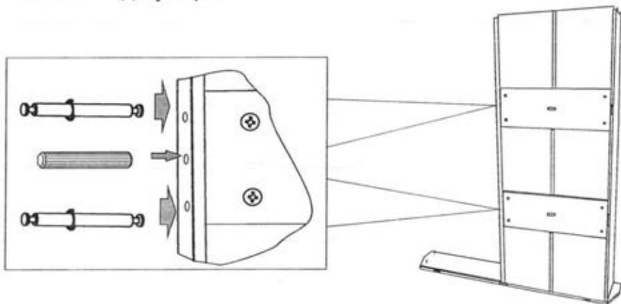
Установить ребра жесткости 01.05 и зафиксировать на эксцентриковую стяжку.
