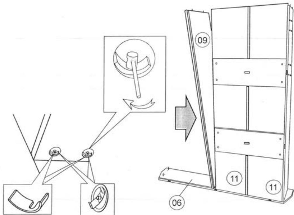
В крайние отверстия на пласти перегородки установить соединительные винты длинной частью до эксцентриков ребер жесткости 01.05. Закрепить ребра жесткости к перегородке на эксцентриковую стяжку. Во внутренние отверстия установить шканты 8x60 до упора.
