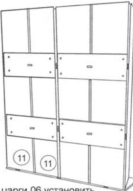
На винты поперечной царги 06 установить правую продольную царгу 08, совместив винты и шканты с отверстиями сопрягаемых деталей. В отверстие вставить сегмент и с помощью шила завернуть винт кроватной стяжки до упора.
