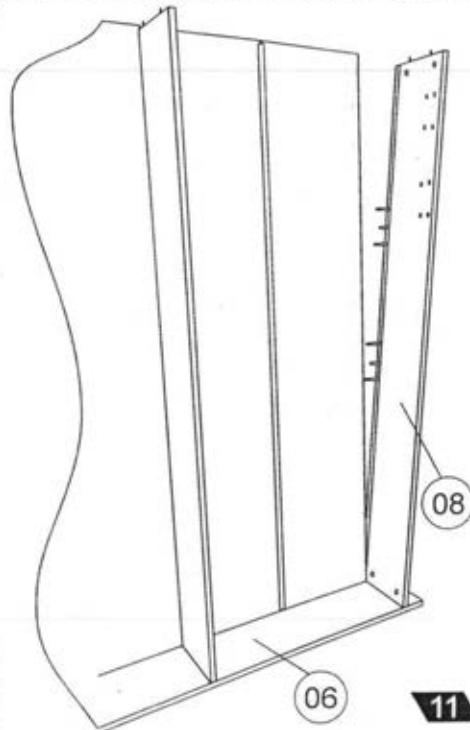
Крепить ребра жесткости к царге продольной правой при помощи эксцентриковой стяжки.
