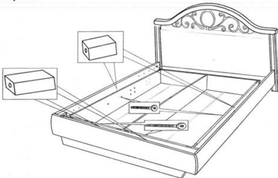
Между боковыми и продольными царгами установить приставки длиной 77 мм и зафиксировать царги между собой при помощи винтов M8x110. Между ножной и поперечной царгой установить приставки длиной 103 мм и зафиксировать царги между собой при помощи винтов M8x130.
