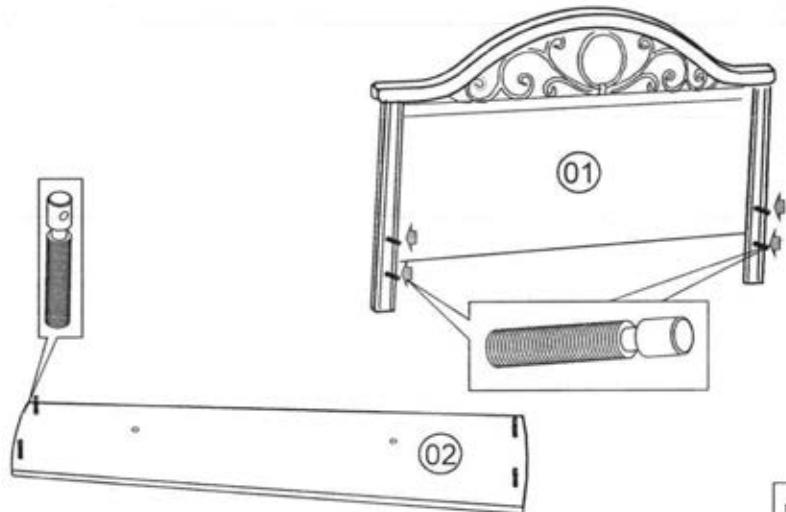
В гайки поперечной царги 10 на 1-2 оборота ввернуть 6 винтов стяжки кроватной.
