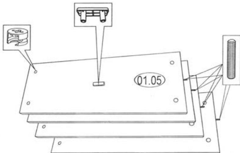
Положить царгу поперечную 06 на прокладочный материал на ровную поверхность винтами вверх. На винты поперечной царги 06 установить левую продольную царгу 07, совместив винты и шканты с отверстиями сопрягаемых деталей. В отверстие вставить сегмент и с помощью шила завернуть винт кроватной стяжки до упора. В отверстие вставить заглушки. Во избежание поломки деталей придерживайте царгу.
